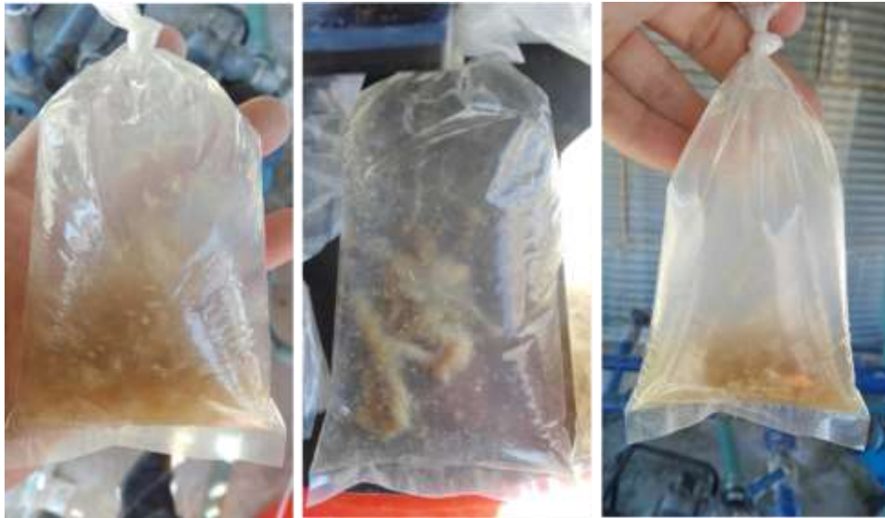
Figura 17: Desprendimiento de Biofilm en tuberías.
