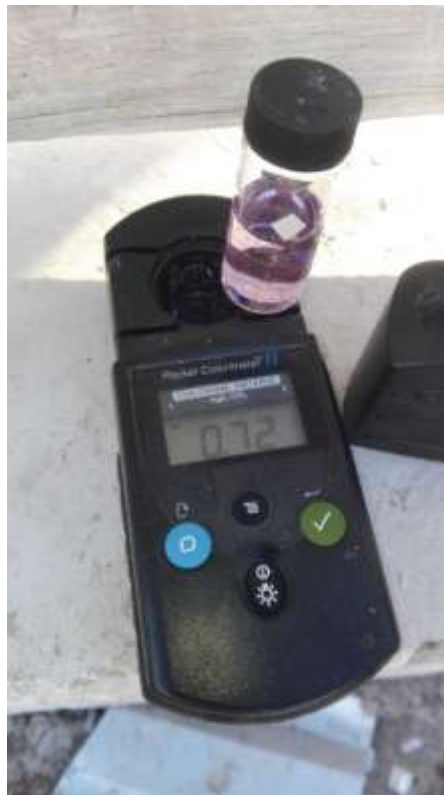
Figura 14: Medición de Residual de Dióxido de cloro.
